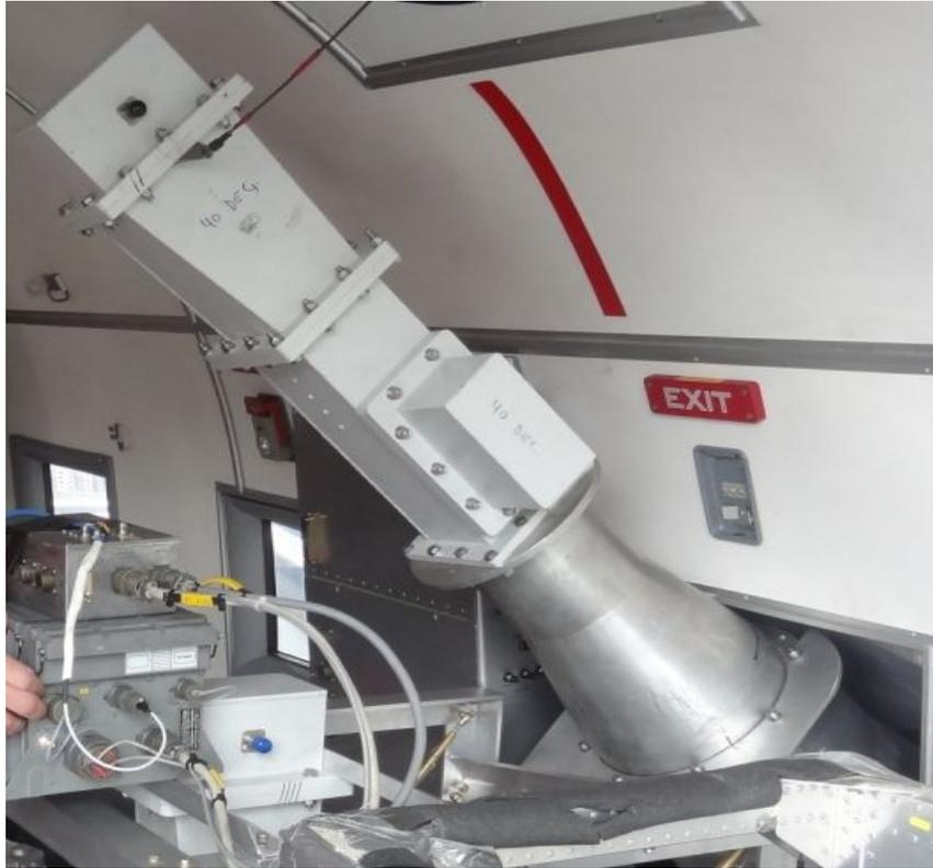
**EMIRAD2 L-band radiometer**
